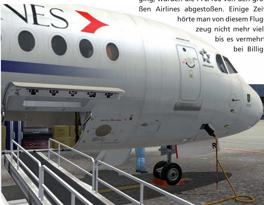
Blick in den Laderaum, auf das Förderband und das Kabel der Bodenversorgung.
