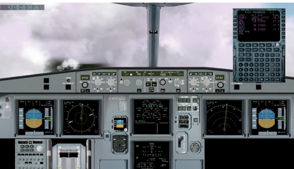
Add Ons gibt es auch: Das PanelA320 des X-Plane 10 mit eingblendeter U-FMC-CDU.
